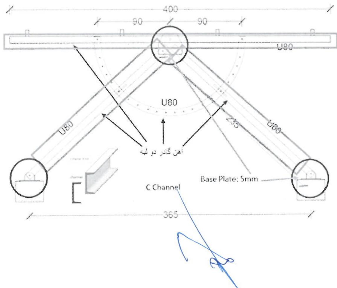
نها چهار تیر آهن که سولر ها روی آن نصب میشود از پروفیل 40x80 گالوانیز شده گرم می باشد
